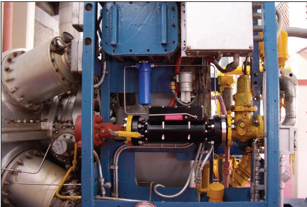
■ La turbina a gas Ruston TB-5000 con la AGV 10 (válvula de gas) de Continental Controls Corporation instalada después de su modernización.
